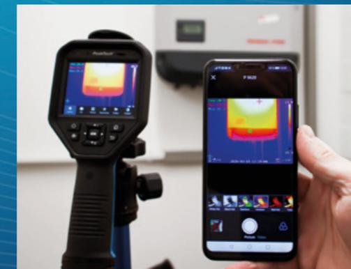
Professionelle Wärmebildkamera mit WiFi Schnittstelle: Werten Sie thermische Fehlerquellen auch an schwer erreichbaren Orten aus und speichern die Messdaten zur späteren Analyse.
