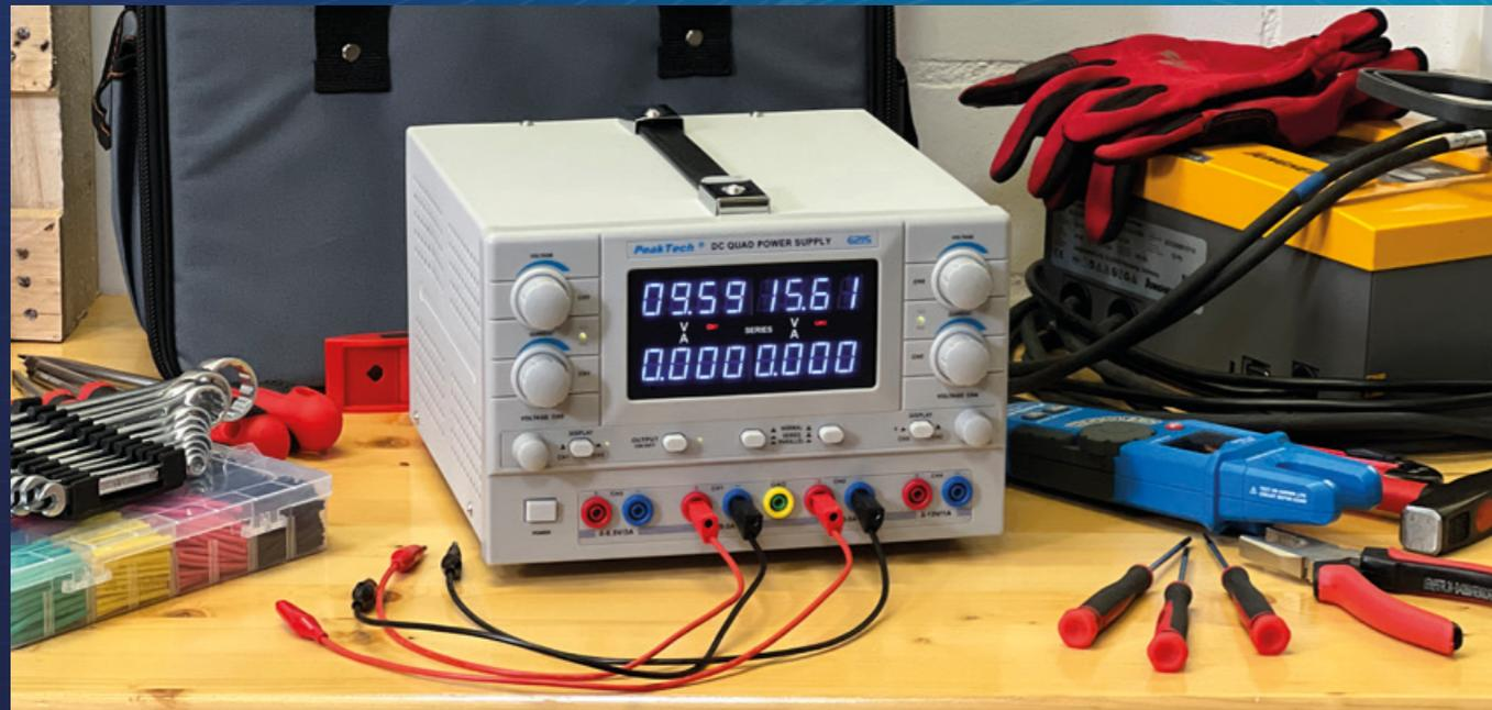
Labornetzgeräte bieten eine Vielzahl an Einstellungsmöglichkeiten um Gleich- und Wechselspannungen sowie Ströme für unterschiedliche Verbraucher und Entwicklerboards auszugeben und sind damit unverzichtbare Betriebsmittel für die Reparatur, Wartung und Entwicklung von Platinen und Komponenten.
