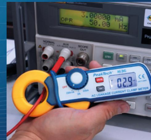
Kriechstromzange im Einsatz: Messen Sie kleinste Ströme präzise mit einer hohen Auflösung bis zu 0,1 mA.
